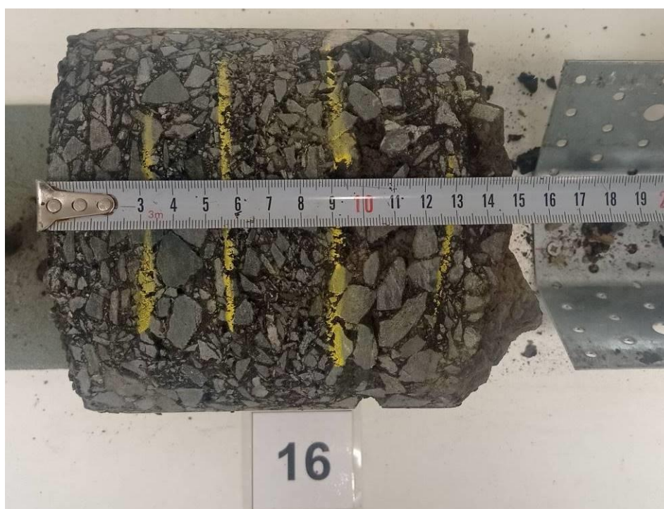
Detail vývrtu JV 16
